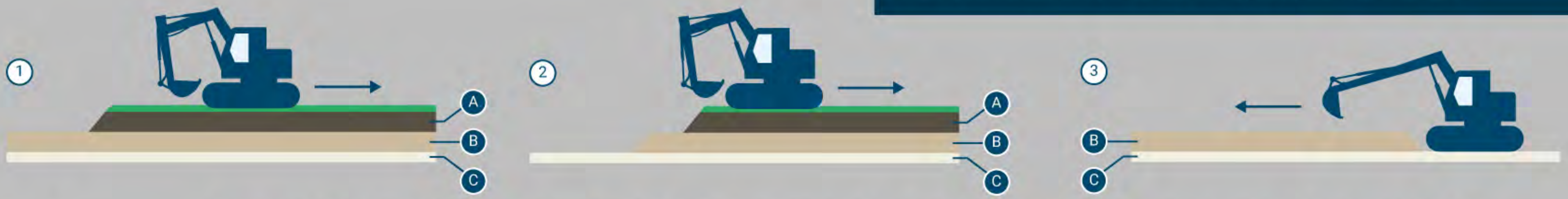
Décapage de l'horizon A (1) et de l'horizon B, selon deux méthodes possibles (2 ou 3). L'engin roule sur l'horizon A et sur le C, mais pas sur le B.
